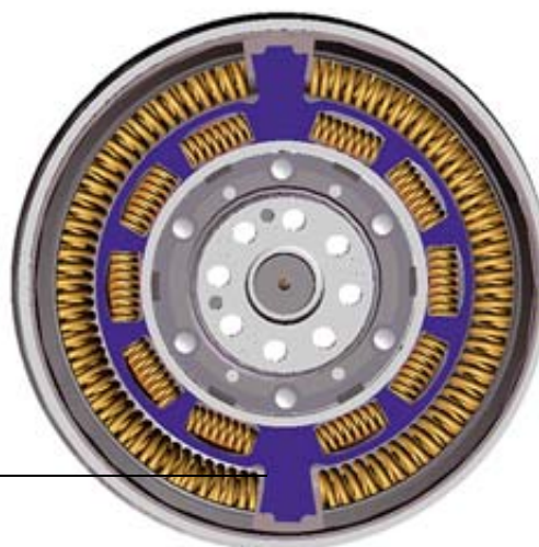
Dvojhmotový zotrvačník so štvornásobným delením a vnútorným tmičom
