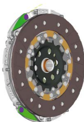
Spojka zložená z prítlačného kotúča a spojkovej lamely
